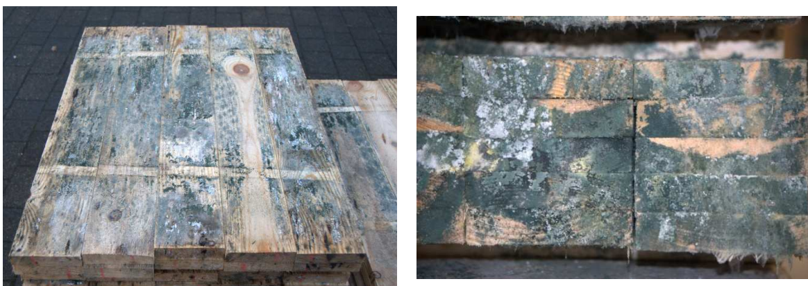
Bild 1: Schimmelbefall an nicht sachgerecht gelagertem Schnittholz
